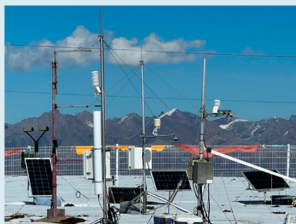
Ejemplo de una estación hidrometeorológica automatizada INARCH desplegada en una cuenca de alta montaña: Montañas Qilian, China
