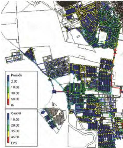
Figura 3. Modelo Hidráulico del Sector Sur de Monclova
