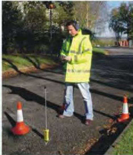
Sistema Leak Sizer en funcionamiento
