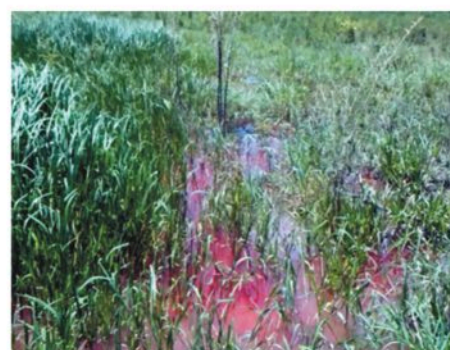
Ilustración 4. Ubicación de fugas en zona pantanosa aplicando colorante vegetal.
