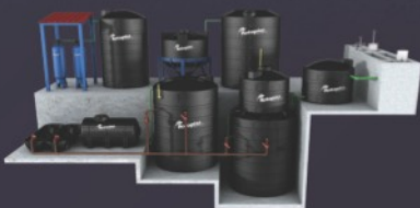
Planta de tratamiento para aguas residuales
