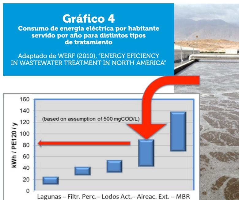
Por ejemplo, en Brasil hace ya varios años que los reactores anaeróbicos de flujo ascendente (RAFA o UASB, por las siglas en inglés), combinados con filtros percoladores o pequeños sistemas de lodos activados para pulimento, se vienen utilizando con éxito y a un CapEx y OpEx considerablemente inferiores a los de lodos activados tradicionales, sin por eso impactar en la calidad requerida del efluente final.
