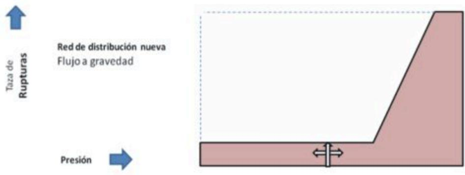
**Fig. 2.2.** Un sistema nuevo aun con transitorios opera bien dentro del rango de la presión máxima de diseño.
