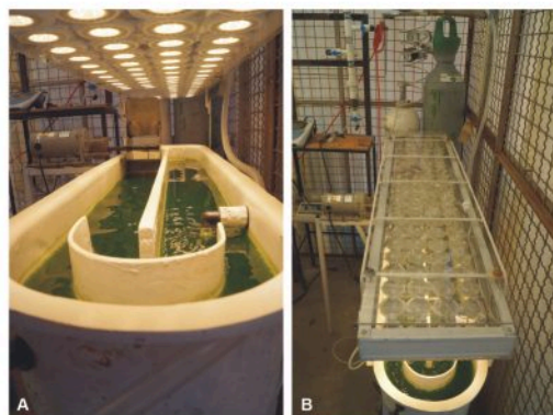
Figura 1. A) Fotobiorreactor de laguna de alta carga HRAP de 30 litros B) Fotobiorreactor de laguna de alta carga HRAP acoplado a proceso de depuración de biogás.
