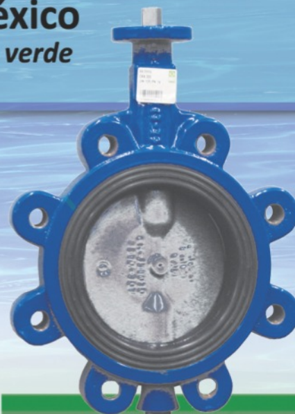
VAG CEREX® Válvula de mariposa tipo wafer de sello elástico. Diseño bridado con disco disponible en hierro ductil y acero inoxidable.
