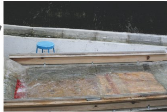
Figura 1. Tanque amortiguador trapecial modelado numéricamente y el dispositivo real correspondiente.
