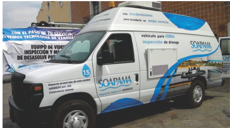
Vehículo con equipo de video inspección de drenajes.
