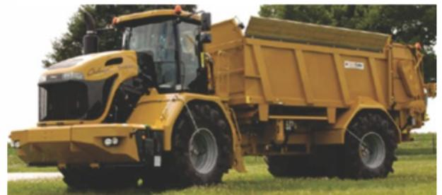
Figura 4. Terragator (vehículo esparcedor de biosólidos).
