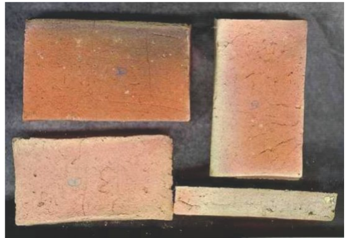
Tabiques de lodo residual.
