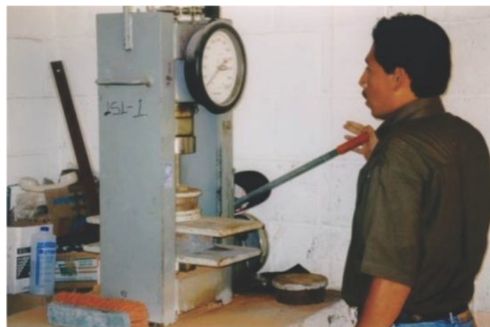
Prueba de resistencia de tabique.
