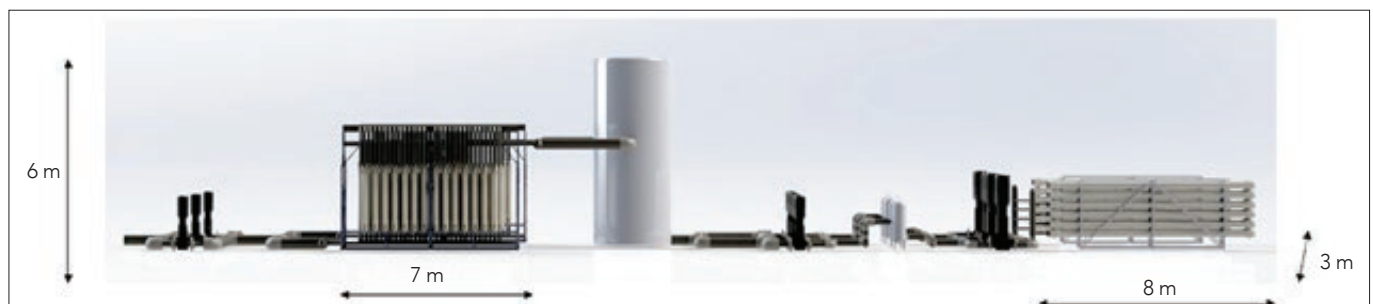
Figura 1. Tren de pretratamiento. Izquierda (7 m): ultrafiltración; derecha (8 m): ósmosis.
