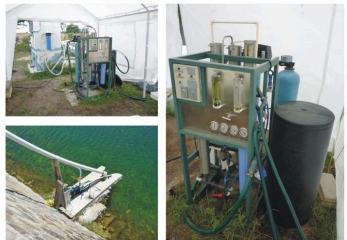
Figura 1. Planta piloto de nanofiltración instalada en uno de los manantiales del valle de tula.
