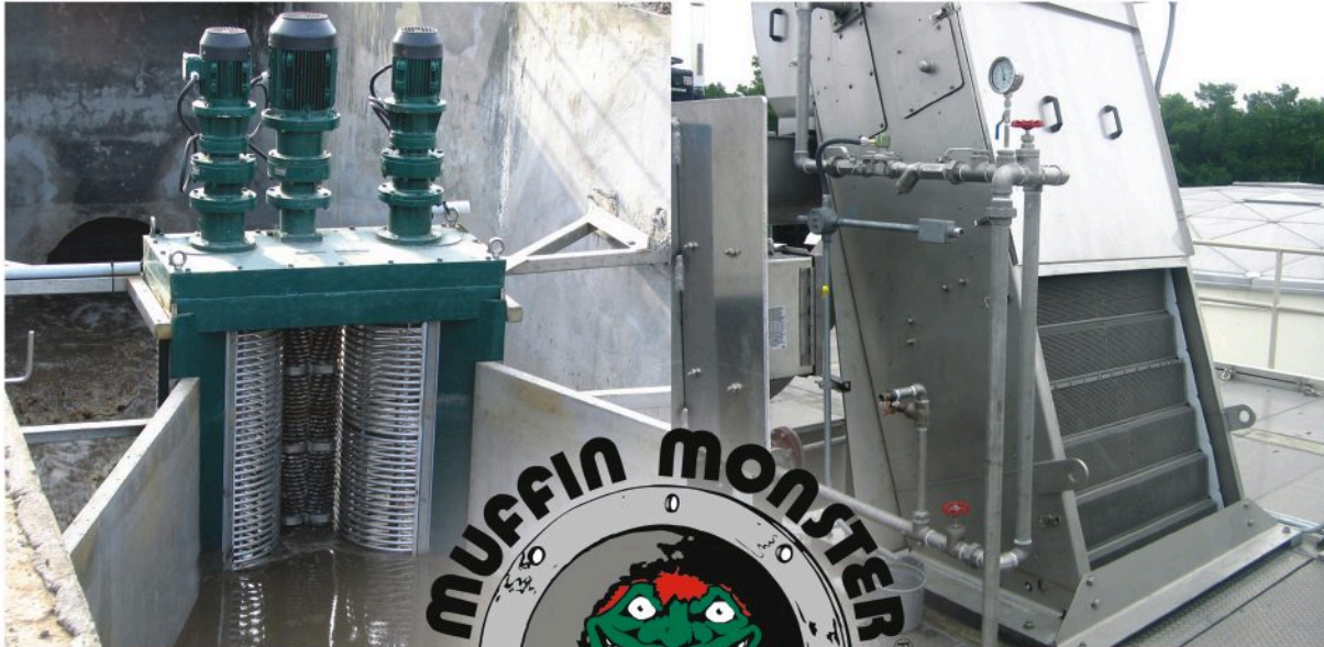
Channel Monster® Unidad para canal abierto
