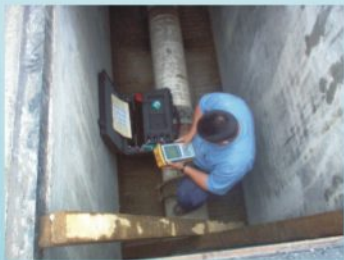
Foto 1. Medición de gasto con aparato ultrasónico.
