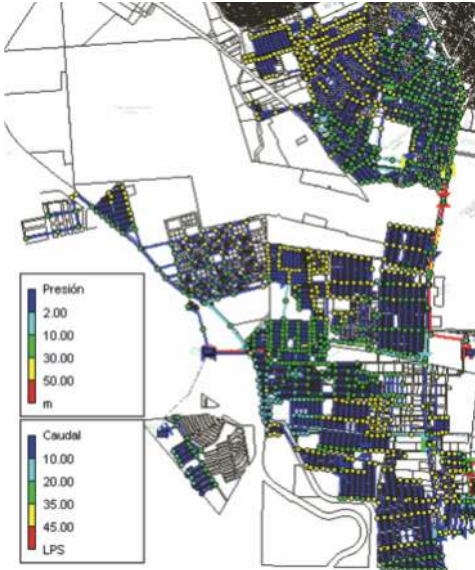
Figura 3. Modelo Hidráulico del Sector Sur de Monclova
