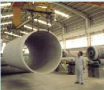
● **Tubería para conducción de agua a presión Clase A**
