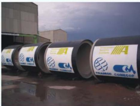
Este tubo, que se está instalando en el Aeropuerto de la Ciudad de México, tiene características muy particulares por la ubicación y el procedimiento de instalación seleccionados. Lleva doble jaula, una virola de acero de mayor longitud y espesor, bastones de unión entre armado y virola, 4 orificios para inyección de bentonita y recubrimiento exterior epóxico RP-5B.
